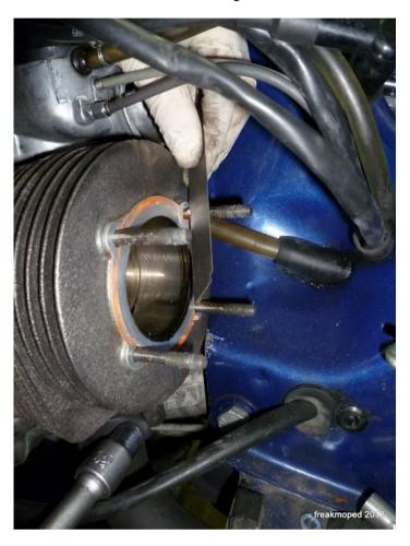
auf jedem stehbolzen 2 muttern mit nuss und ringschlüssel kontern (dh die muttern gegengleich verdrehen, sodass sie fest auf dem stehbolzen sitzen) (125: M7, 200: M8)
