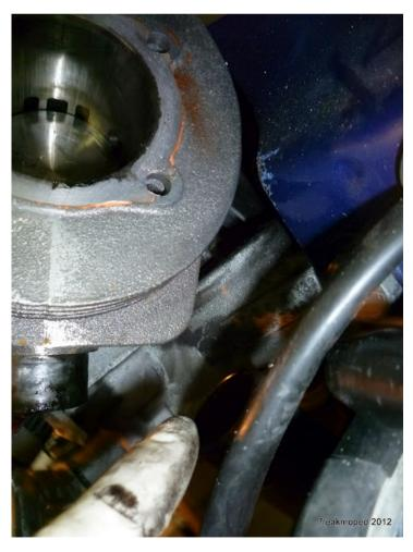
5) zum schutz des kolbens und der –ringe (der ja frei herumbaumelt..) wird ein tuch um pleuel und kolben im bereich der kolbenringe gewickelt
