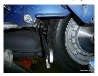
2) mit 13er nuss und ratsche auf der motorseite die mutter am auslassstutzen lösen.
