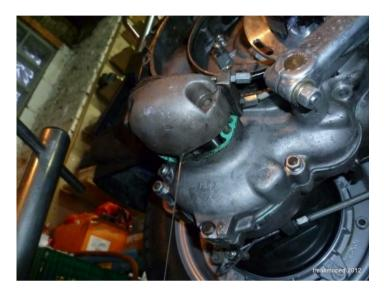
4) schaltgriff in den 4. gang drehen und raste ganz abziehen – etwas kippen und ausfädeln aus der schaltstange – das hakelt ein wenig. diese dann auf das trittbrett legen oder zb die schaltzüge unter dem hauptständer eingeklemmen.
